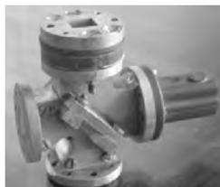
Рис.8. Расчетные и экспериментальные значения коэффициента передачи трехдецибельного крестообразного делителя (а); внешний вид делителя (б)
