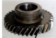
Նկ.1. Փոխանցումների տուփի երկրորդային լիսեռի կոտրվածքները և մաշը. ա, բ - հոգնածային քայքայում, գ - փխրուն քայքայում, դ - հենարանային մասի մաշը
