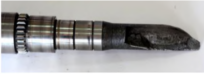
Նկ.1. Փոխանցումների տուփի երկրորդային լիսեռի կոտրվածքները և մաշը. ա, բ - հոգնածային քայքայում, գ - փխրուն քայքայում, դ - հենարանային մասի մաշը
