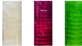
Նկ. 3 Ակրիլամիդի մետաղական կոմպլեքսների ՖՊ ստացված նմուշների նկարները. Mn(AAm)_4(NO_3)_2 – (1), Co(AAm)_4(NO_3)_2 – (2), Ni(AAm)_4(NO_3)_2 – (3)
