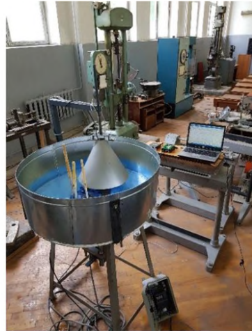
Նկ. 11. Ջրային միջավայրում բույսերի վիբրացիոն կտրման փորձարարական տեղակայանքի ընդհանուր տեսքը:
