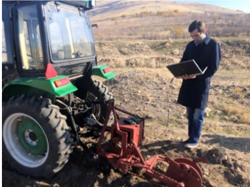
Նկ. 4 Տեխնիկական պարամետրերի գրանցման սարքավորումներով համալրված ֆրեզային ագրեգատը դաշտում փորձարկումների ժամանակ
