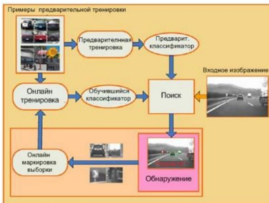
Рис.3. Принцип работы системы Camera Vision на основе искусственного интеллекта
