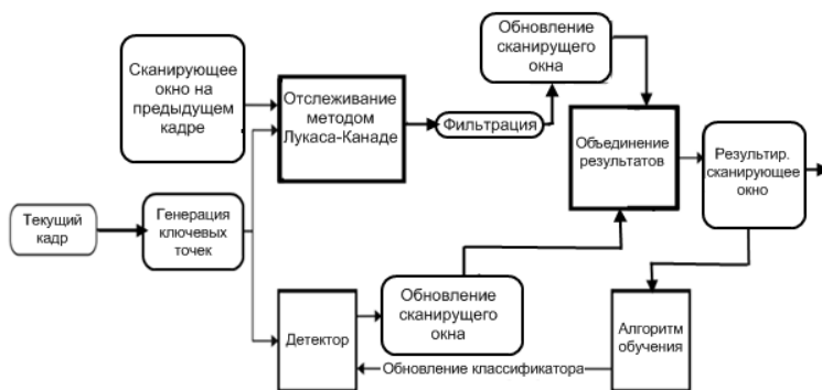
Рис.10. Архитектура системы детектирования и отслеживания объектов
