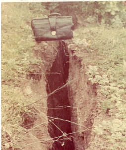
Նկ. 1. Դեյուվյալ գոյացումներում սողանքի մարմնի պոկման ճեղքը
