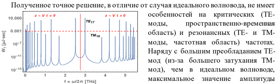
Рисунок 3: Спектральное распределение излучения дипольной моды ( n=1 ) в волноводе с медными стенками; излучение вперед (справа) и назад (слева).
