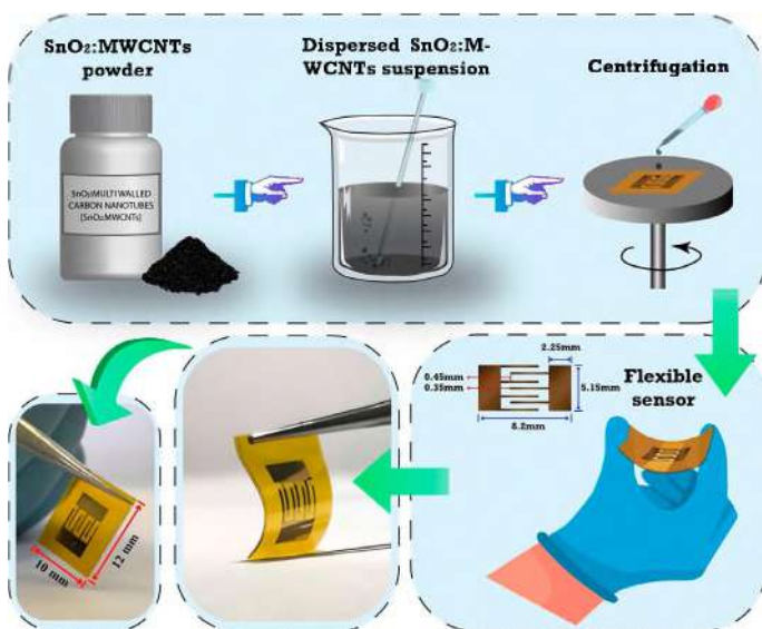
Նկ. 26 \text{SnO}_2/\text{PU}/\text{MS} սենսորի պատրաստման տեխնոլոգիական քայլերը և լուսանկարները:
