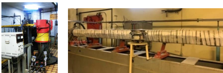
Рис. 2. Слева – третий клистронный пост после восстановления; справа – 4-я ускоряющая секция (без экранирующих кожухов) с протяженными компенсирующими катушками.
