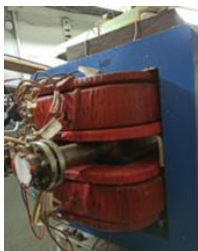
Рис. 7. Поворотный магнит параллельного переноса с дополнительными обмотками
