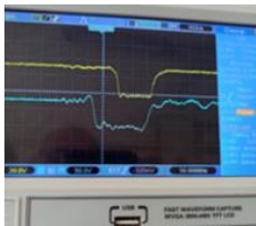
Рис. 4. Нижний луч оциллограммы — импульс восстановленного модулятора; верхний луч — огибающая СВЧ-импульса.
