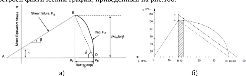
Рис.10 Приблизительный вид шляпкообразной модели Друкера-Прагера, состоящей из двух частей (а), и фактический график типичной шляпкообразной модели Друкера-Прагера при p_b = 100 МПа (б)
