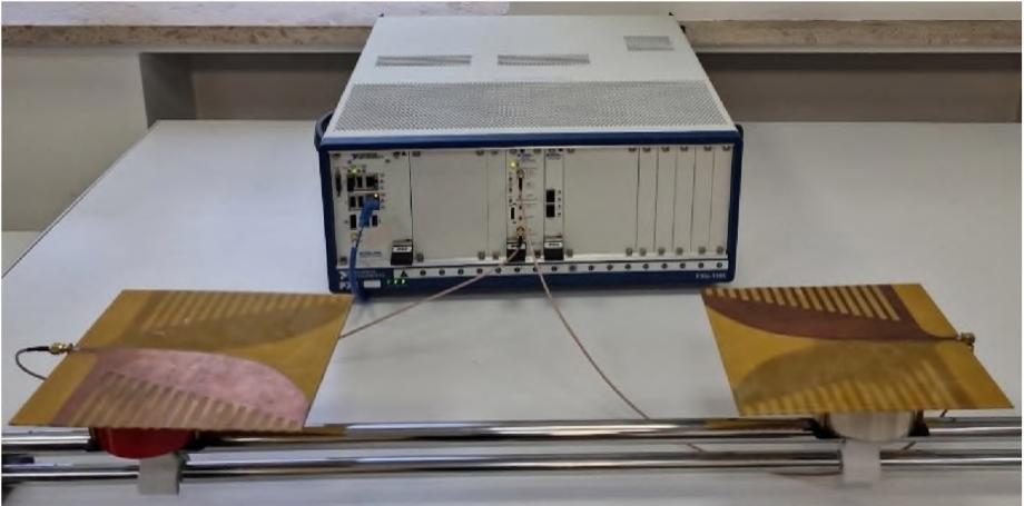
Рис. 7. Система обнаружения и распознавания цифровых модулированных сигналов на базе PXIe-5841
