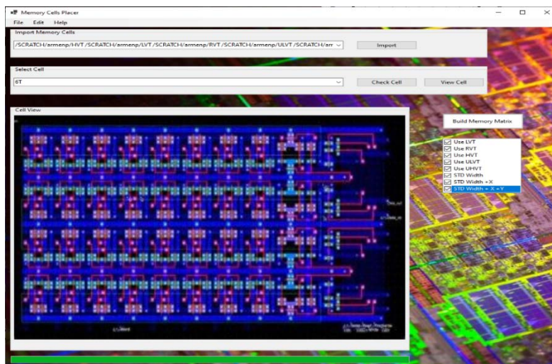
Рис.13. Проектирование ЗН на основе 6Т (width+x+y) ЗЭ
