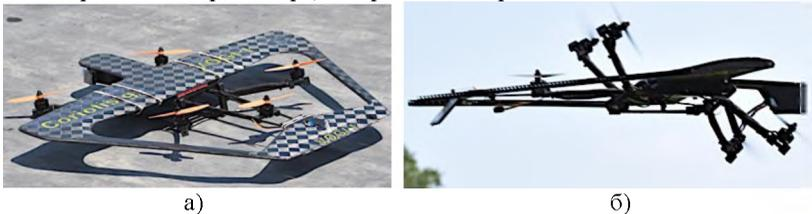
**Рис. 2.1. БПЛА с ВВП\_РТ с развязкой по тангажу**
