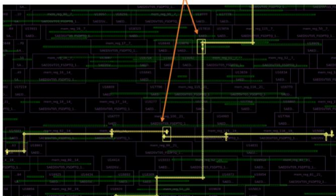
Рис. 14. Изменение взаимного расположения проводов после установки повторителей
