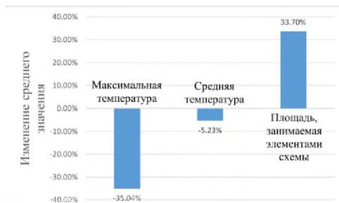
Рис. 13. Средние значения изменений показателей в результате оптимизации параметров транзисторов в различных схемах
