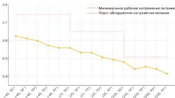
Рис. 8. Нижний рабочий порог напряжения питания ПУН
