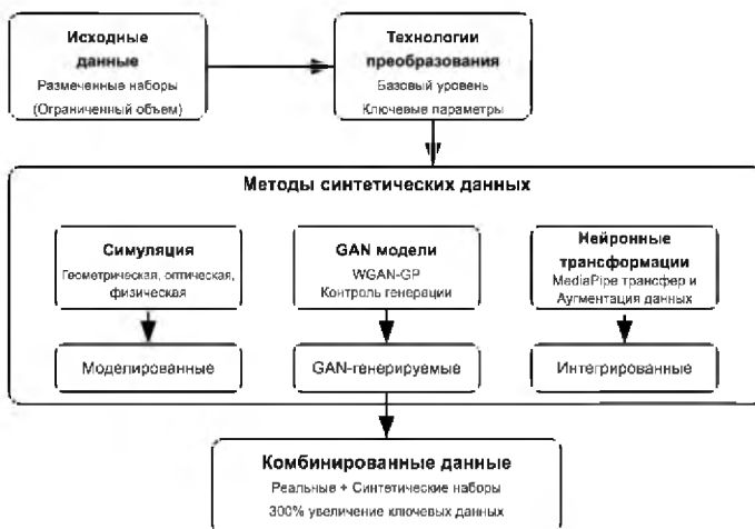
Рис. 12. Создание синтетических жестов с применением генеративных состязательных сетей
