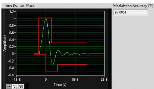
Рис. 10. Измерение точности модуляции на пакете UWB
