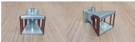
Рис. 11. Тестируемая рупорная антенна для проверки подлинности измерительной системы
