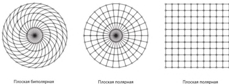
Рис. 4. Геометрические конфигурации плоских измерений в ближней зоне
