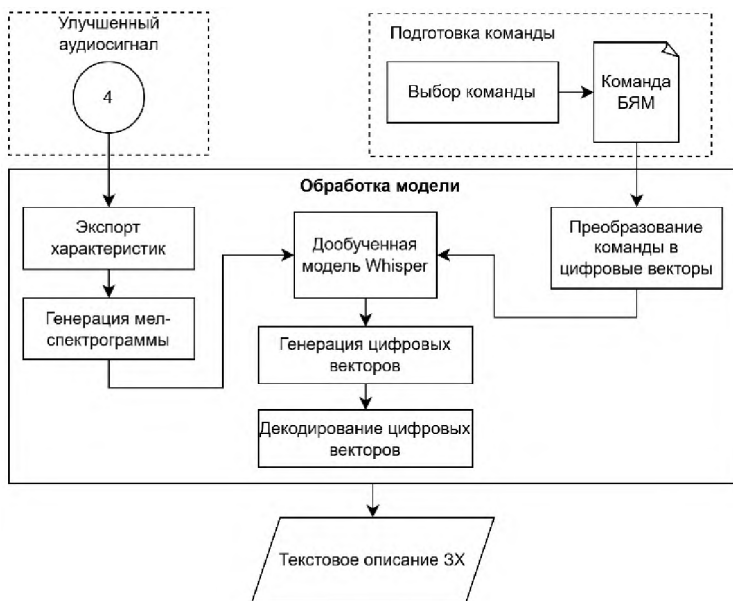
Рис. 10. Способ получения текстового описания звуковых характеристик из видеоматериалов
