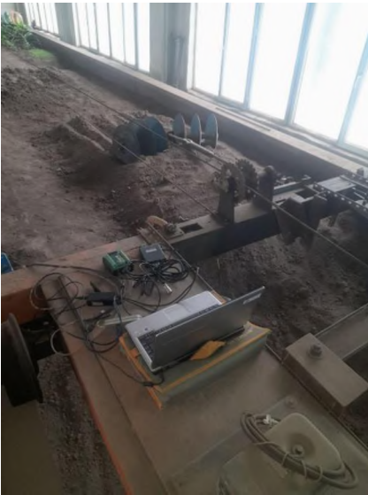
Նկ.7. Սկավառակային մարտկոցների լաբորորատոր գիտափորձերի համար նախապատրաստված հողային խրամատը՝ շարժական սայլակով:
