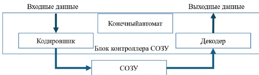
Рис. 4. Контроллер памяти с механизмом исправления ошибок кода
