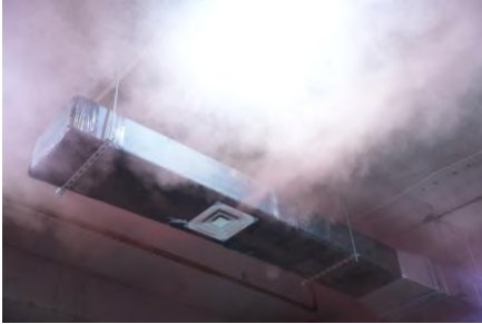
Նկ.11 Օդի հոսքի պատկեր շերտավոր դիֆուզորի կիրառմամբ
