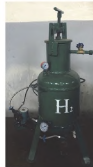
Նկ. 7. Դյուրակիր ջրածնային գեներատորի կառուցվածքի սխեմատիկական պատկերը (ձախից) և ընդհանուր տեսքը (աջից)
