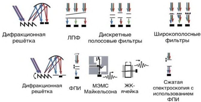
Рис. 1. Основные методы получения и фильтрации спектра излучения
