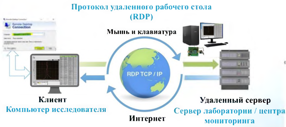
Рис.14. Дистанционный спектральный анализ с помощью RDP
