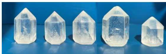
Рис. 1. Выращенные монокристаллы \alpha -LiIO 3 , \alpha -LiIO 3 :L-Arg, \alpha -LiIO 3 :L-Ala, \alpha -LiIO 3 :L-NNA и \alpha -LiIO 3 :Gly.
