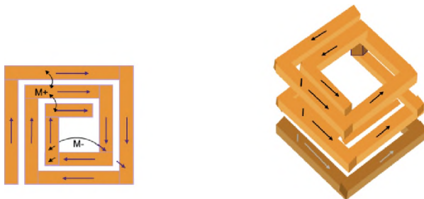
Рис. 1. Физическая модель возникновения ВММ
