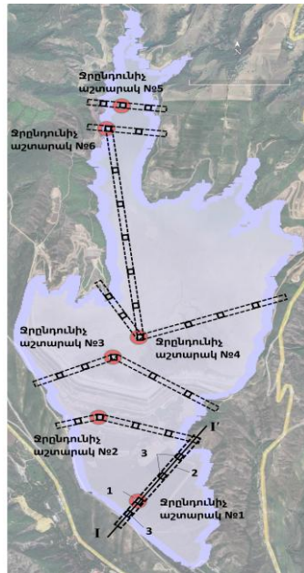
Նկ. 9. Մետաղական կամրջային անշարժ հարթակների և ջրընդունիչ աշտարակների տեղադրման սխեման Արծվանիկի պոչամբարի տարածքում 1 - ջրընդունիչ աշտարակ, 2 - աշխատանքային մետաղական հարթակ, 3 - աշխատանքային մետաղական հարթակի հենասյուներ
